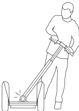
Figure 29. Séparation du guidon / cadre LeanSteer de la base pivotante
