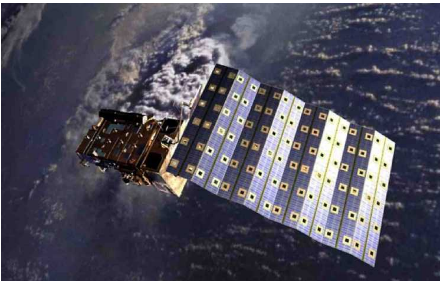
MetOp, 18 mètres de long avec ses panneaux solaires déployés, analyse les vaguelettes à la surface de la mer et permet de reconstituer la vitesse et la direction du vent. Il a été lancé en 2006. PHOTO ESA
