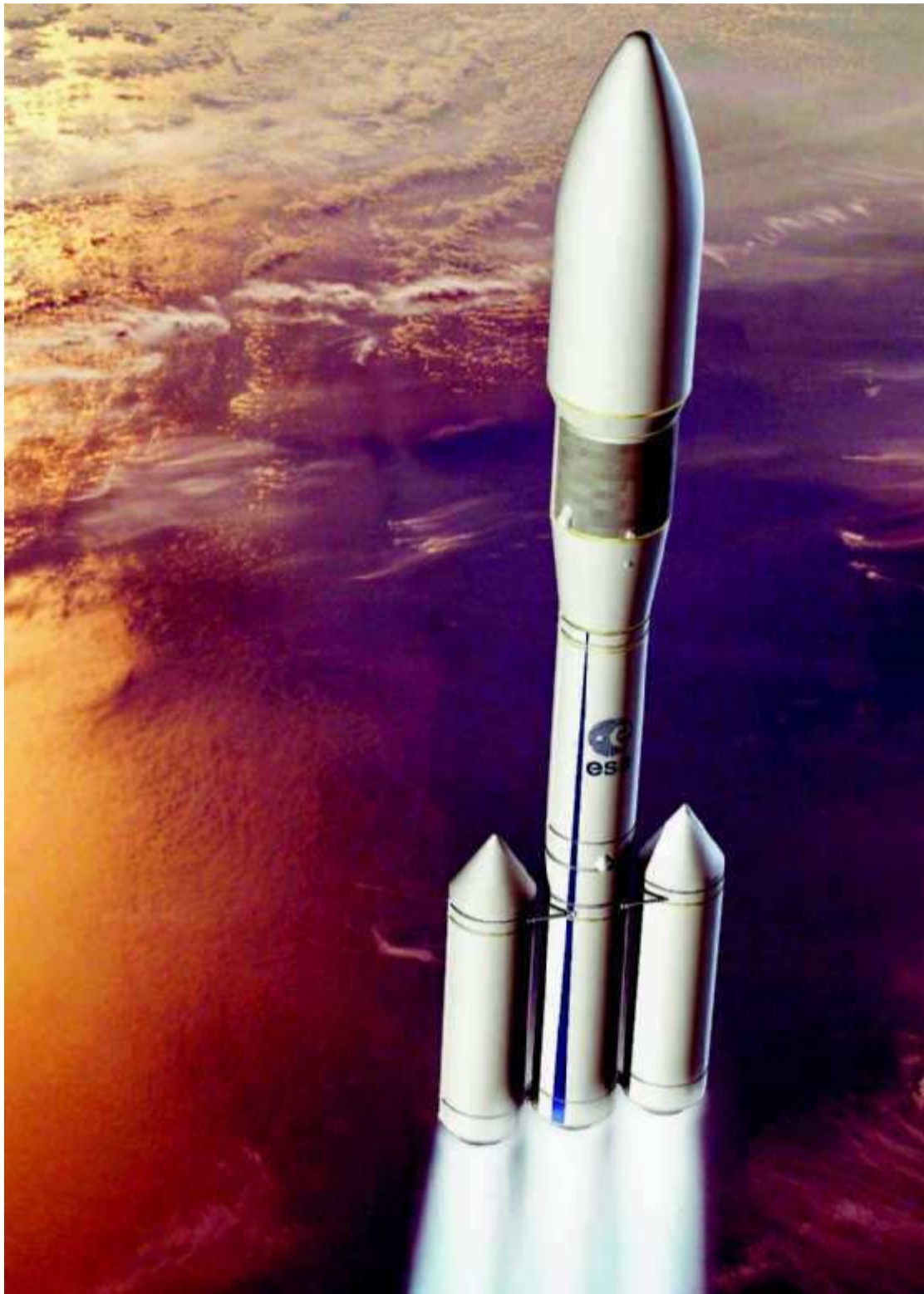
Les fusées Ariane 6 pourront être équipées de deux, quatre ou six boosters. ILLUSTRATION ESA
