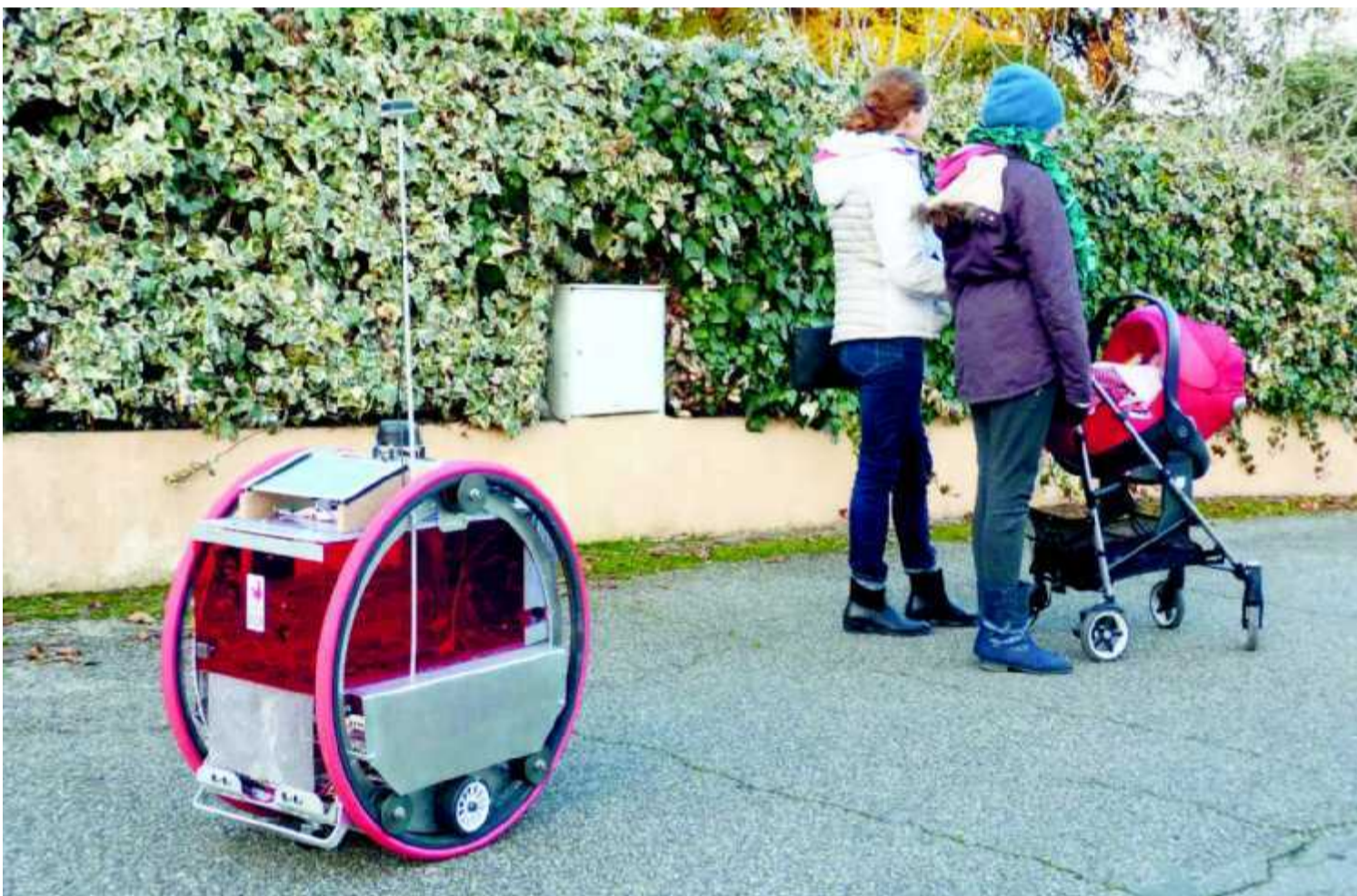
Le prototype du robot de livraison de TwinswHeel se déplace seul dans la rue et envoie un SMS annonçant son arrivée. PHOTO DR
